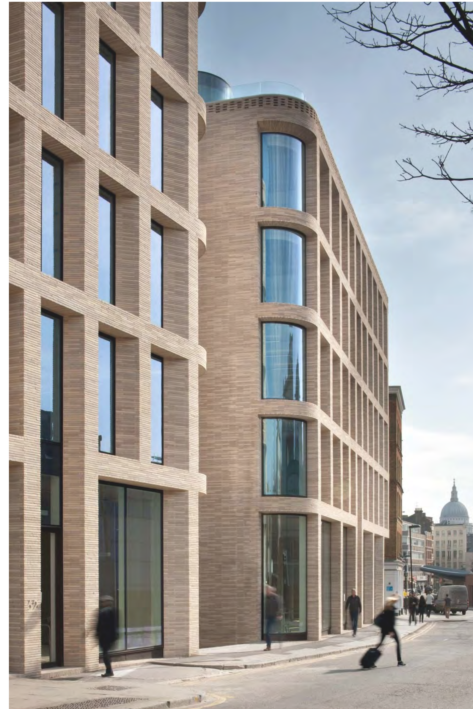
referentie Lichte / Zandkleurige wasserstrich baksteen, hilversums formaat (ca 42x105x225/280mm), vormstenen waar nodig. Gestreken voegen, 4mm terugliggend, op kleur gemaakt grijs.
