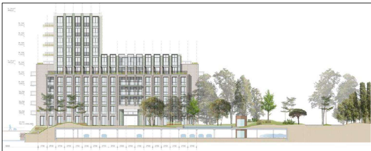
Figuur 3: Parkeergarage onder maaiveld
