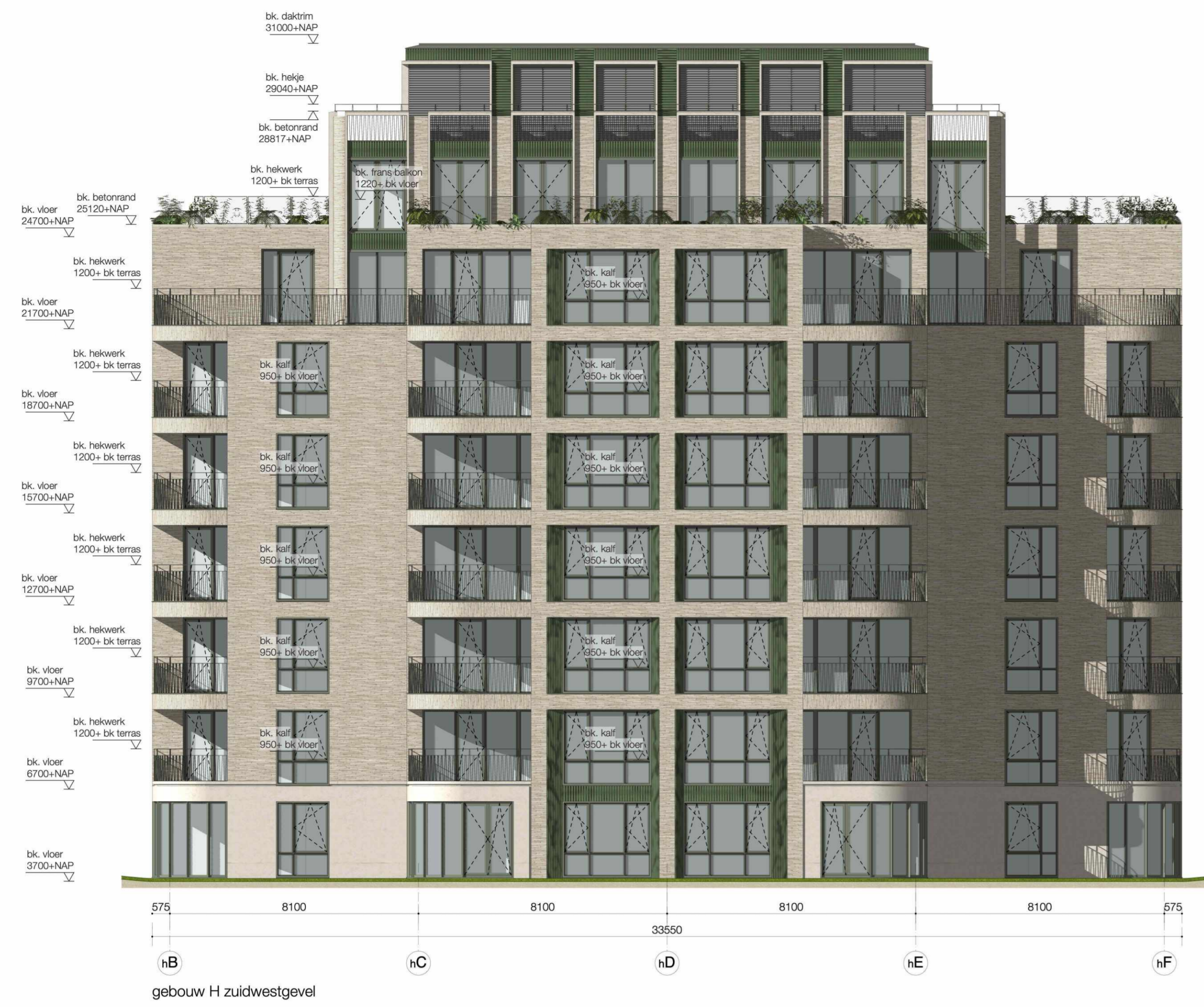
gebouw H zuidwestgevel
